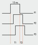
T1 = P1 + P2 + P3 = 3 elettropiloti simultanei T2 = P2 + P3 = 2 elettropiloti simultanei
